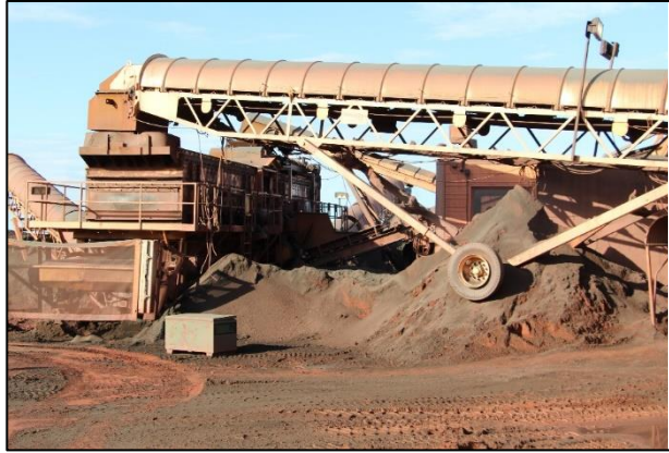
Photo 15: Accumulation de fines sous le tapis transporteur du concasseur
