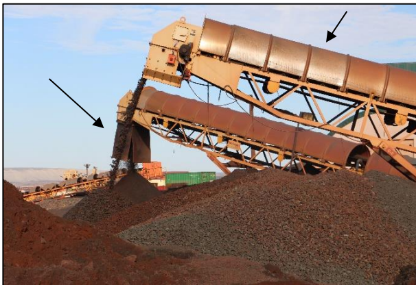
Photo 12: Caches et soufflets sur la glissoire
