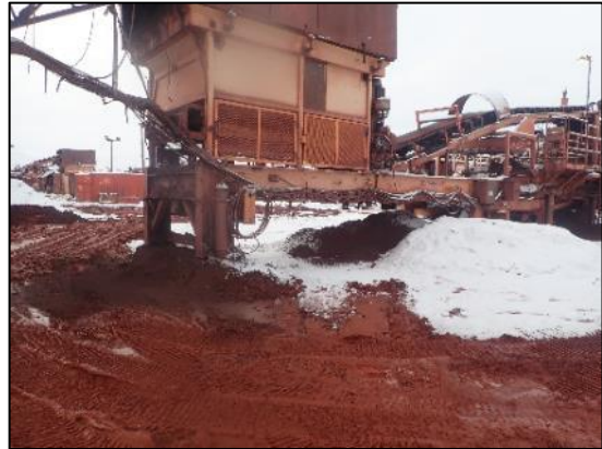
Photo 16: Accumulation limitée de minerai sous l'équipement du concasseur
