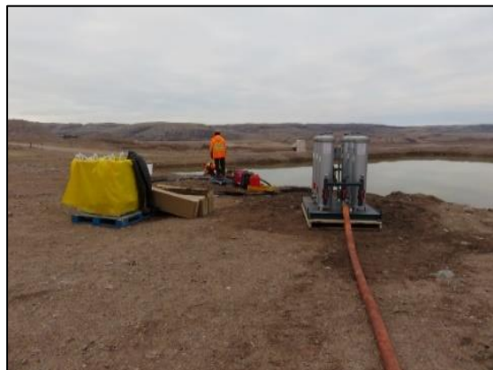
Photo 60: Système de traitement des solides et sac Quadrex pour les filtres usagés.
