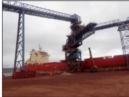
Photo 66: Quai minéralier et chargeur de navires au port de Milne
