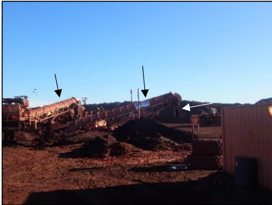
Photo 15: Caches et soufflets sur la courroie du convoyeur du concasseur
