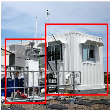
Figure 1 - Certains des instruments proposés pour cette étude ont été déployés à Halifax lors d'une étude semblable. Nous montrons ici une remorque avec notre équipement et quelques instruments qui échantillonnent les particules de l'air extérieur.
